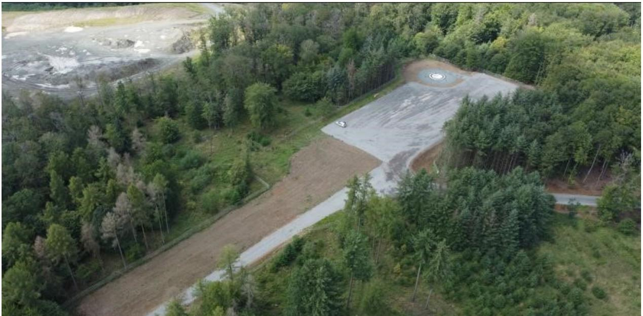
*Abbildung: Die Fundamente der Windkraftanlagen sind fertiggestellt, auch die notwendigen Kranstellflächen wurden vorbereitet. Im weiteren Verlauf sind letzte Vorbereitungen für die Anlieferungen der Rotorblätter notwendig. Quelle: Koehler-Gruppe*
